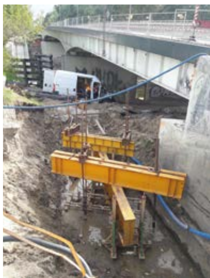
Fot. 5. Próbné obciążenie mikropali na podporze 4. kładki
