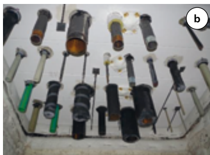
Fot. 1. Elementy próbnego uszczelnienia przejść instalacyjnych zamontowane w standardowej sztywnej konstrukcji mocującej o małej gęstości: a) ściana z bloczków z betonu komórkowego, b) strop z płyt z betonu komórkowego
