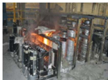
Fot. 5. Pożar konstrukcji badawczej wywołany zbyt gęstym rozmieszczeniem elementów próbných w badaniu
