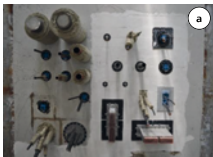
Fot. 2. Elementy próbnego uszczelnienia przejść instalacyjnych zamontowane w standardowej sztywnej konstrukcji mocującej o dużej gęstości: a) ściana betonowa, b) strop żelbetowy
