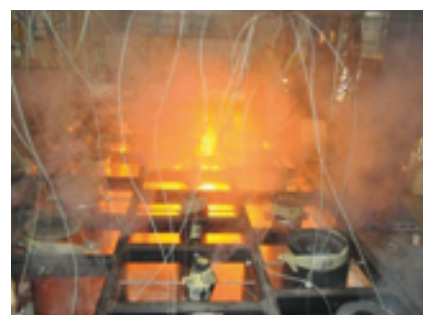
Fot. 5. Pożar konstrukcji badawczej wywołany zbyt gęstym rozmieszczeniem elementów próbných w badaniu
