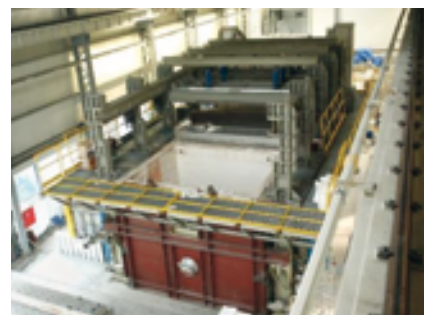
Fot. 4. Po lewej: piec pionowy o wymiarach 7 x 10 m (wysokość x szerokość); po prawej: 3-komorowy piec do badań głównie elementów poziomych 4,3 x 11,35 m [4]. Pokazane piece do badań znajdują się w Laboratorium Badań Ogniowych ITB w Pionkach
