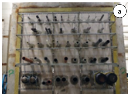
Fot. 1. Elementy próbnego uszczelnienia przejść instalacyjnych zamontowane w standardowej sztywnej konstrukcji mocującej o małej gęstości: a) ściana z bloczków z betonu komórkowego, b) strop z płyt z betonu komórkowego
