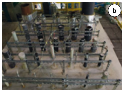
Fot. 2. Elementy próbnego uszczelnienia przejść instalacyjnych zamontowane w standardowej sztywnej konstrukcji mocującej o dużej gęstości: a) ściana betonowa, b) strop żelbetowy
