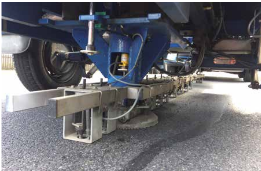
Fot. 2. Widok na belkę pomiarową ze stalową płytą obciążeniową i czujnikami – geofonami
