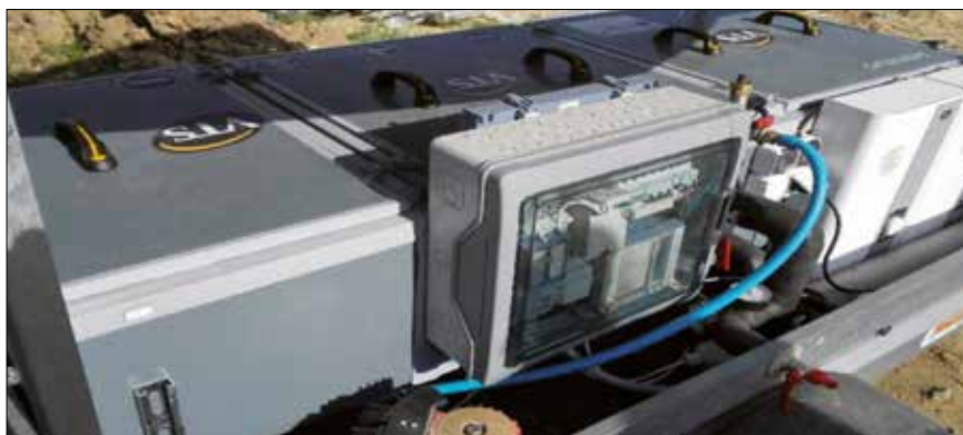
Fot. 1. Stanowisko badawcze PCFCHHVAC1700 z zespołem pomiarowym i sekcją podgrzewaczy elektrycznych 2 x 20 kW oraz z nagrzewnicą elektryczną 36 kW
