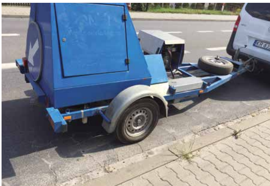
Fot. 1. Ugięciomierz dynamiczny FWD do pomiarów punktowych
