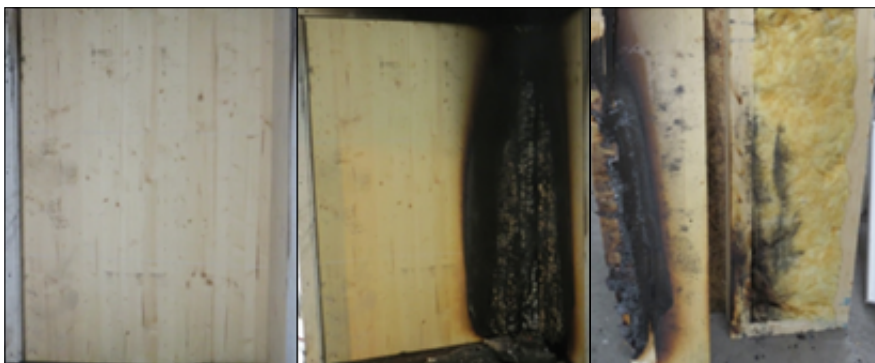
Fot. 1. Próbką do badań wg PN-EN 13823 (SBI) na stanowisku badawczym przed i po badaniu w ramach reakcji na ogień, pozwalającym na przypisanie cechy nierozprzestrzeniania ognia wewnątrz pomieszczeń (fot. archiwum ITB)
