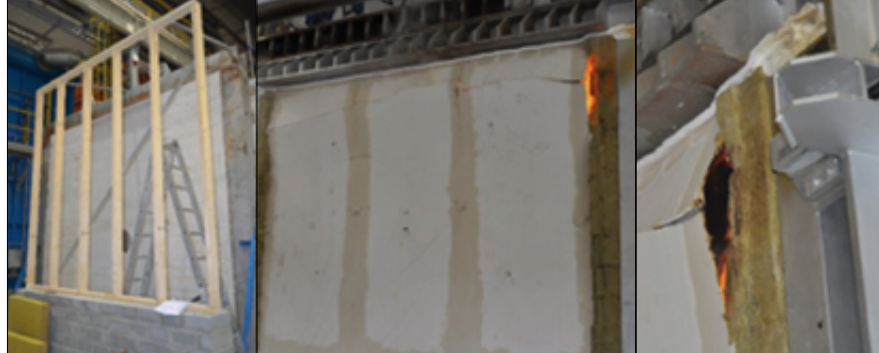
Fot. 2. Szkieletowa ściana nośna o konstrukcji drewnianej przed i w trakcie badania w zakresie odporności ogniowej – obciążenie przyłożone hydraulicznie (fot. archiwum ITB)
