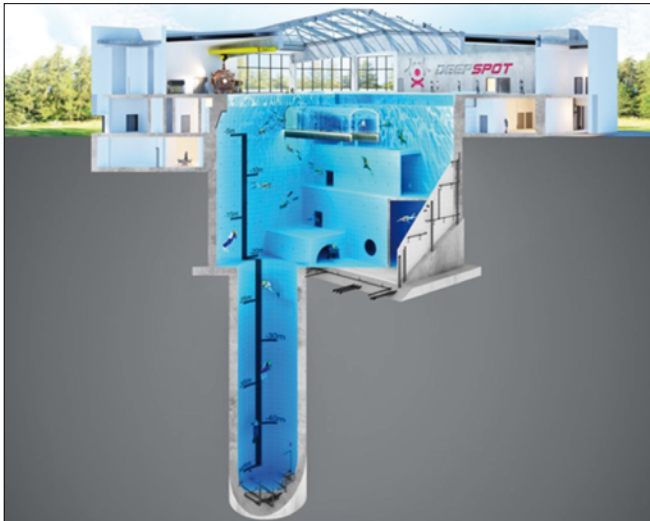
Rys. Schemat kompleksu basenowego DEEPSPOT w Mszczonowie. Komora główna: głębokość 20 m, płyta denna tuby 45,4 m (źródło: https://flyspot.com/pl/deepspot/ )
