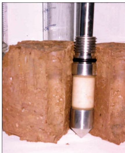
Fot. 3. Końcówka filtrująca piezometru BAT
