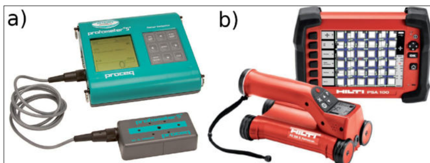
Fot. 6. Sprzęt stosowany do badania i lokalizacji zbrojenia: a) profometr, b) ferroskan
