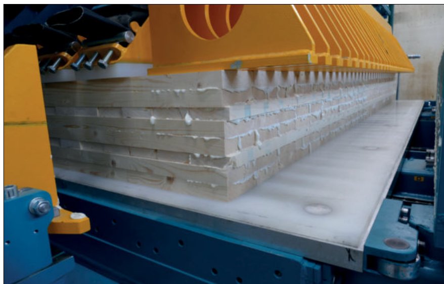
Fot. Klejenie elementu CLT
