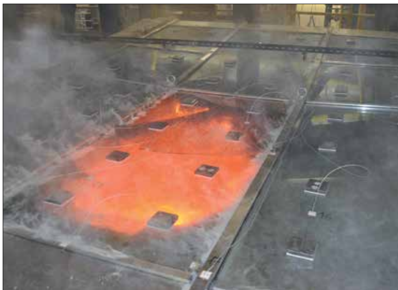
Fot. 4 | Dach z przeszkleniem podczas badania odporności ogniowej (archiwum ITB)
