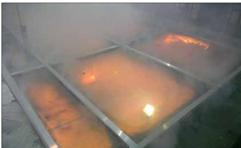
Fot. 2 | Dach z przeszkleniem podczas badania odporności ogniowej (archiwum ITB)
