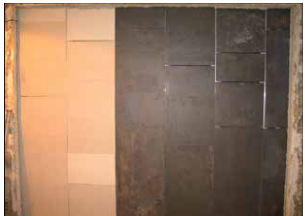
Fot. 2 | Ściana z ociepleniem w technologii lekkiej suchej podczas badań laboratoryjnych (próbka nr 8)
