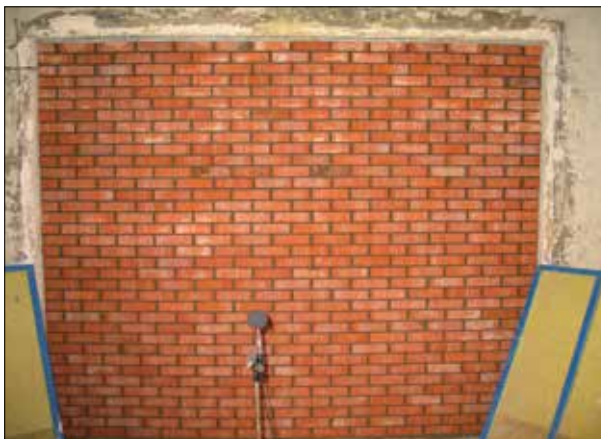
Fot. 1 | Ściana tradycyjna podczas badań laboratoryjnych [2] (próbka nr 7)
