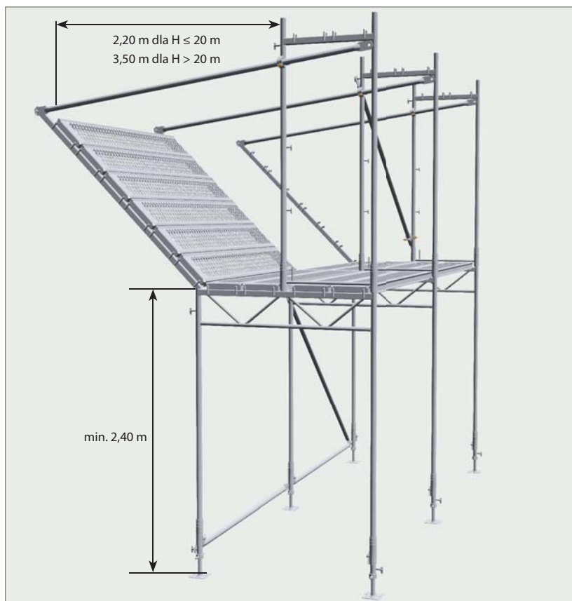
Rys. | Zasada konstruowania daszek ochronnych [12]
