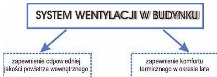
Rys. 3. Zadania wentylacji hybrydowej
