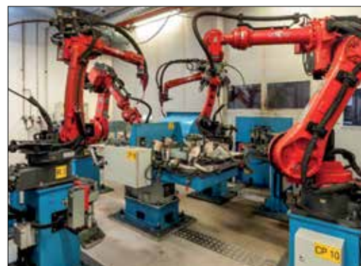
Rys. 4. Roboty do produkcji złązek mechanicznych
