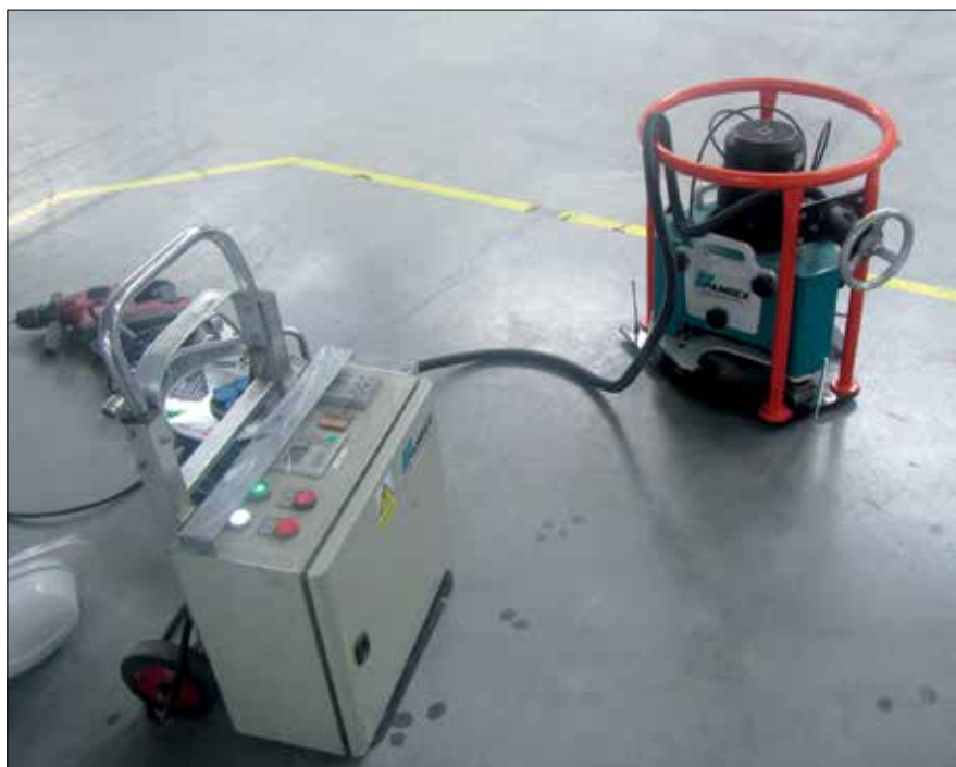
Fot. 2. Aparat do badania ścieralności BCA (fot. archiwum KMD Diagnostyka Budowli)
