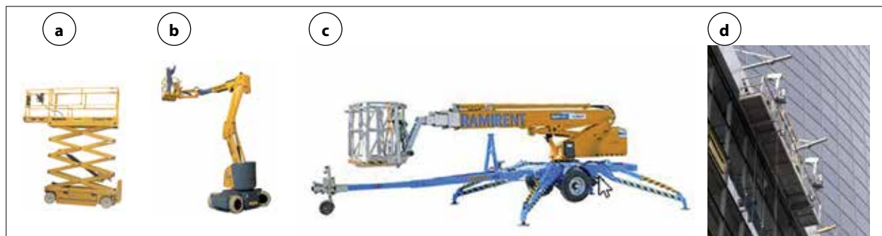
Fot. 6 | Rodzaje ruchomych podestów roboczych: a) wolnobieżne nożycowe (fot. Ramirent), b) wolnobieżne koszowe (fot. Ramirent), c) przewoźne (fot. Ramirent), d) wiszące (fot. Geda [18])
