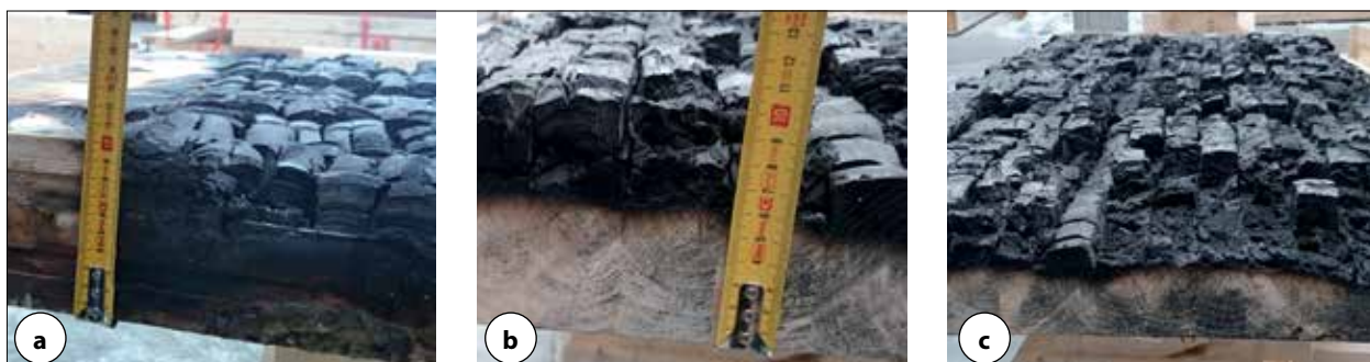
Fot. 9 | Element stropowy po teście ogniowym. Grubość wyjściowa 10 cm, po 60 minutach działania pożaru widoczny ubytek materiału ~ 40 mm, co niejako potwierdza normową prędkość spalania na poziomie 0,7 mm/min. Test zakończony pomyślnie, wynik: REI60; drewno dzięki swoim parametrom doskonale izoluje wysoką temperaturę pożaru od pozostałych pomieszczeń i bez problemu można tworzyć z niego przegrody ogniowe, jak stropy i ściany o odporności REI30 oraz REI60
