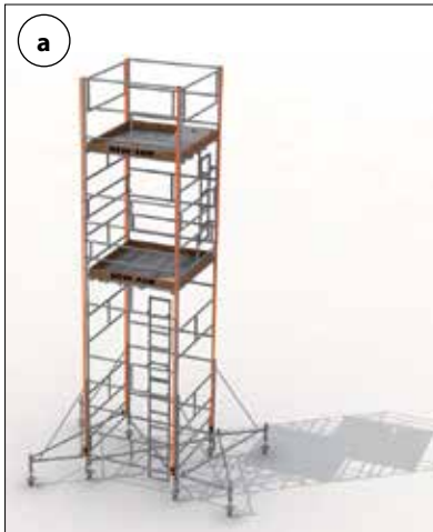
Fot. 4 | Rusztowanie przejazdne typu „Warszawa”: a) prawidłowe zastosowanie (fot. Rew -Ton), b) błędy rusztowania warszawskiego
