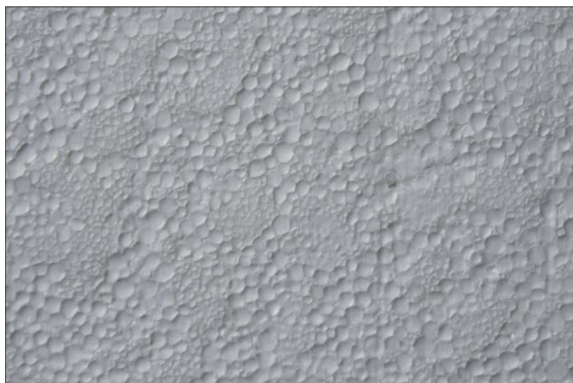
Fot. | Powierzchnia płyty styropianowej z dużą zawartością surowca wtórnego. Widoczne są nierówne obszary różniące się wielkością granulek
