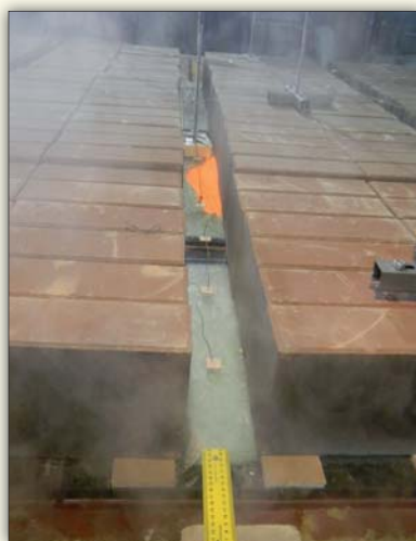
Fot. 6 | Strop szklany od strony nienagrzewanej podczas badania (widoczne obciążenie stropu)
