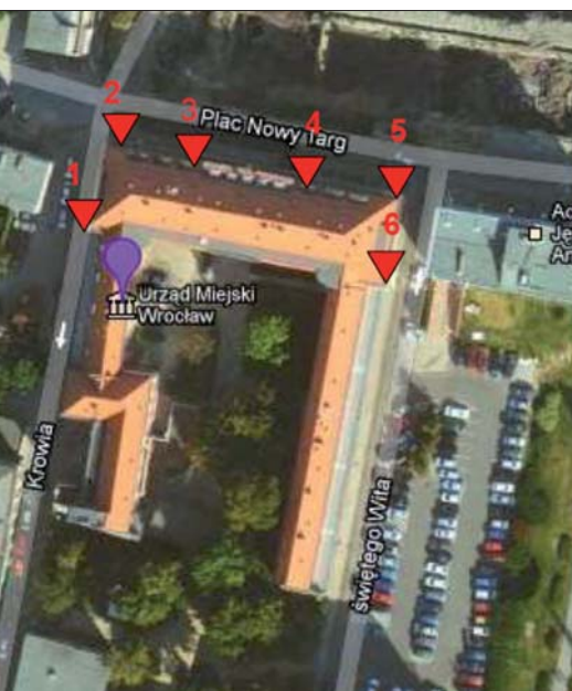
Fot. 6 | Lokalizacja reperów do pomiarów przemieszczeń pionowych na budynku urzędu miejskiego
