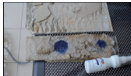
Fot. 9. Płytkę zdjętą z pionowej części boku balkonu; zupełnie inna wartość pH wskazuje na znacznie mniejszą intensywność procesów destrukcyjnych (należy rozpatrywać łącznie z fot. 7 i 8, opis w tekście)
