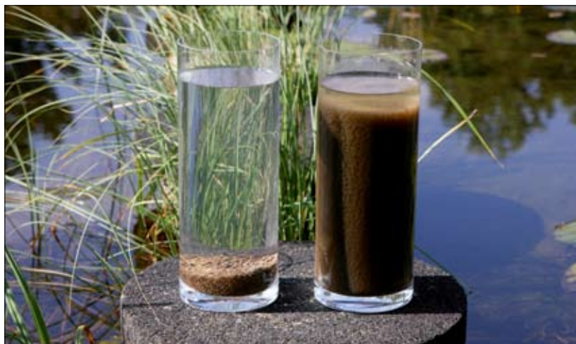
Fot. 1 Właściwości sedymentacyjne. Po 5 minutach osadzenia – osad granulowany z lewej, osad klasyczny z prawej
