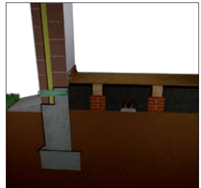
Fot. 4 | Podłoga na gruncie.
