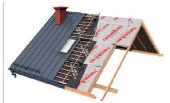
Rys. 2 | Izolacja THERMANO montowana na krokwiowo na dachu skośnym
