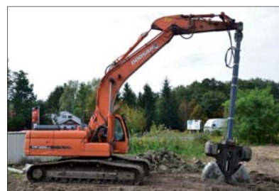
Fot. 6 | Chwytnak do baret zamocowany na koparce
