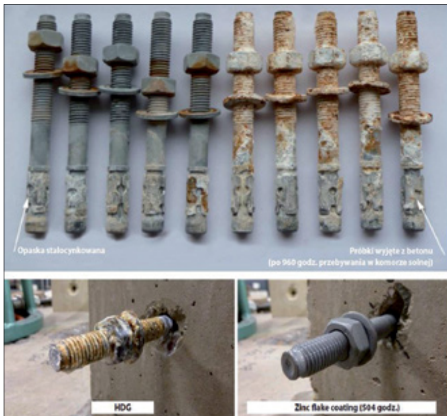
Fot. 5. Próbkę łączników pokrytych powłokami ocynku płatkowego i ocynku ogniowego po pobycie w komorze solnej przez 960 godzin oraz łączników osadzonych w kostkach betonowych po pobycie w komorze przez 504 godziny
