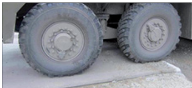
Fot. 1. Próba zastosowania pianobetonu na parkingu w Trencinie, Słowacja [8, 9]
