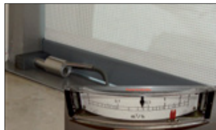
Fot. 14. Sonda kontrolna do wykrywania nieszczelności okien
