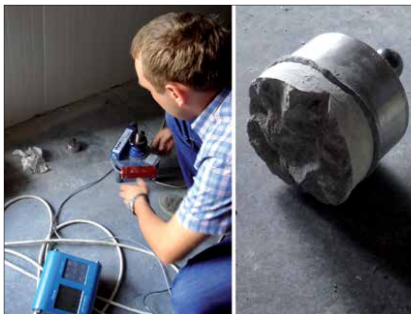
Fot. 11. Badanie wytrzymałości na rozciąganie podkładu betonowego metodą pull-off
