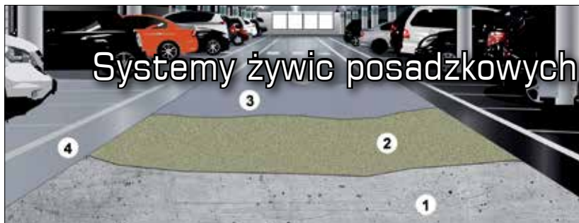
Fot. 1 Posadzka parkingowa: 1) posadzka betonowa; 2) podkład gruntujący Almacoat Primer Concrete®/Primer Concrete Fast®; 0,3 mm; 3) warstwa polimocznikowa Almacoat Floor®; 2–4 mm; 4) farba Almapur Protect®/Almapur VVHS®; 0,3 mm (opcjonalnie)
