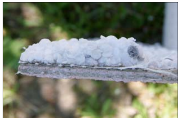
Fot. 4 | Siatka z włókna szklanego zatopiona w zbyt grubej warstwie zaprawy klejącej
