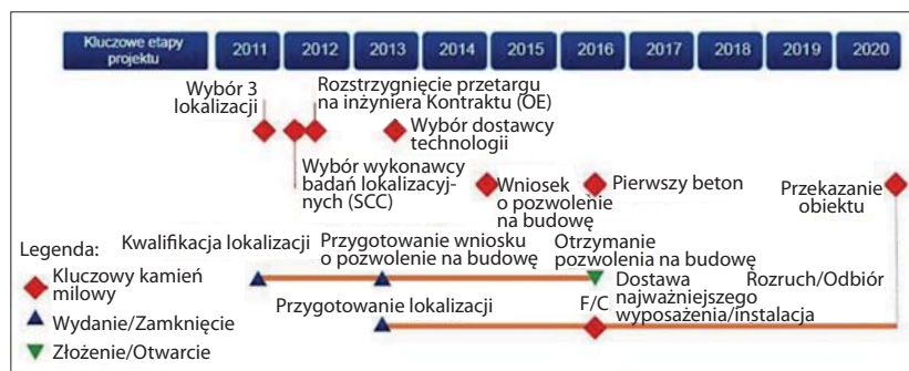
Rys. 1 | Harmonogram realizacji elektrowni jądrowej w Polsce [6]
