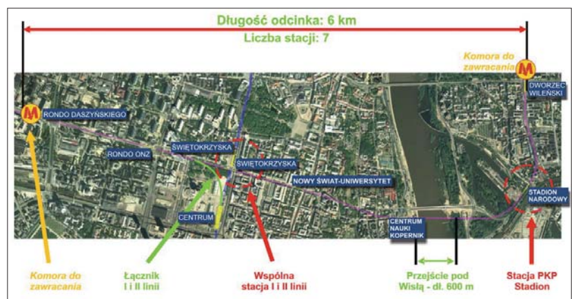
Fot. 1 | Schemat centralnego odcinka II linii metra [2]
