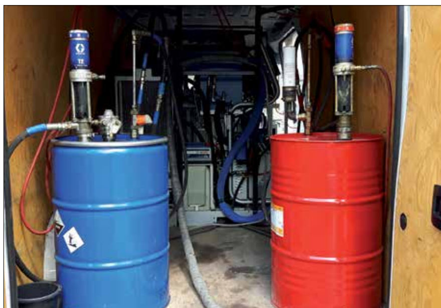
Fot. 1. Komponenty w beczkach do produkcji piany PUR wraz z agregatem do ich aplikacji
