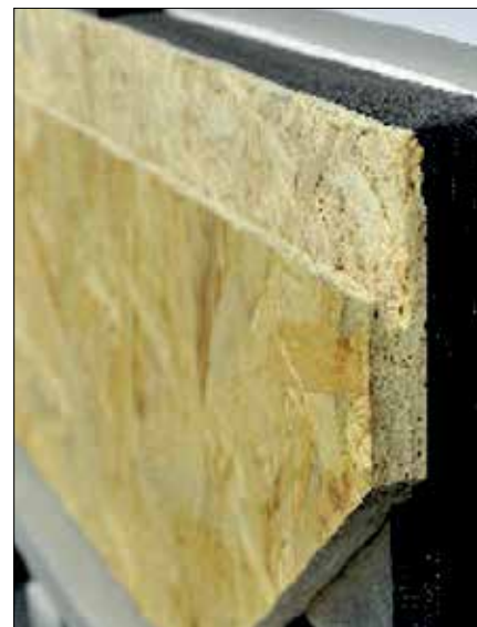
Fot. 3. Płyta zespolona – izolacja próżniowa VIP z płytą OSB [12]
