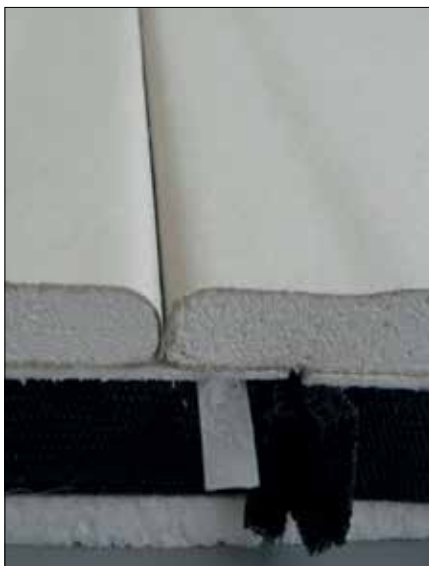
Fot. 1. Płyta zespolona – izolacja próżniowa VIP z płytą g-k [10]
