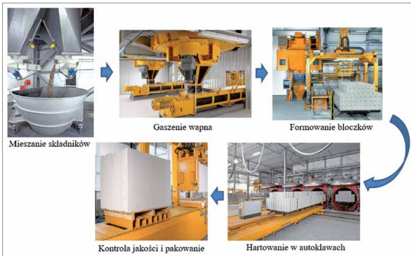
Fot. 2 Przebieg procesu produkcji silikatów (źródło: archiwum firmy SIL-PRO)
