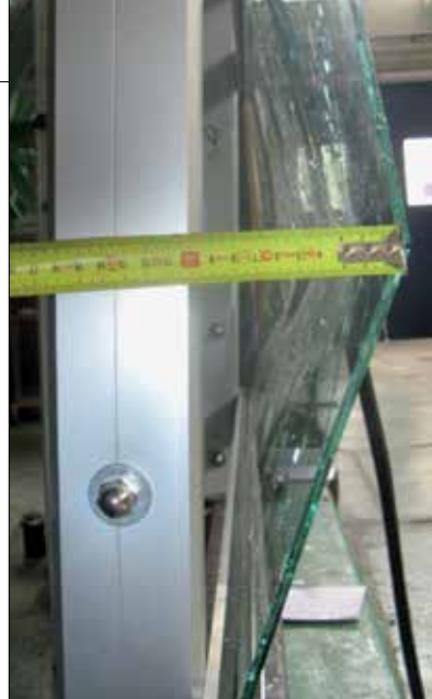
Fot. 1 | Utrata funkcjonalności balustrady po uderzeniu ciałem miękkim i ciężkim 30 kg (archiwum ITB)
