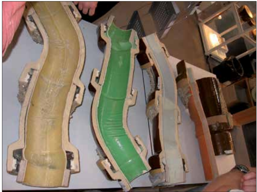
Fot. 1 | Przykłady zainstalowanych rękawów CIPP w przyłączach kanalizacyjnych (fot. autor)
