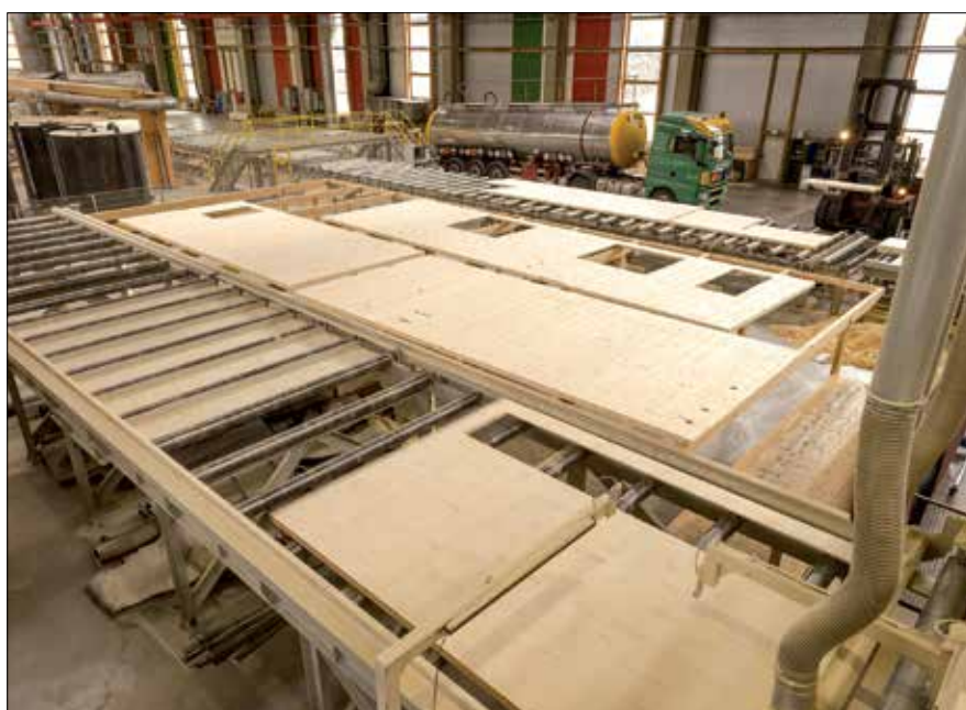
Fot. 5. Gotowa ściana CLT w hali produkcyjnej
