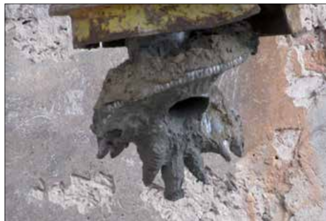
Fot. 4. Zęby skrawające pala CFA
