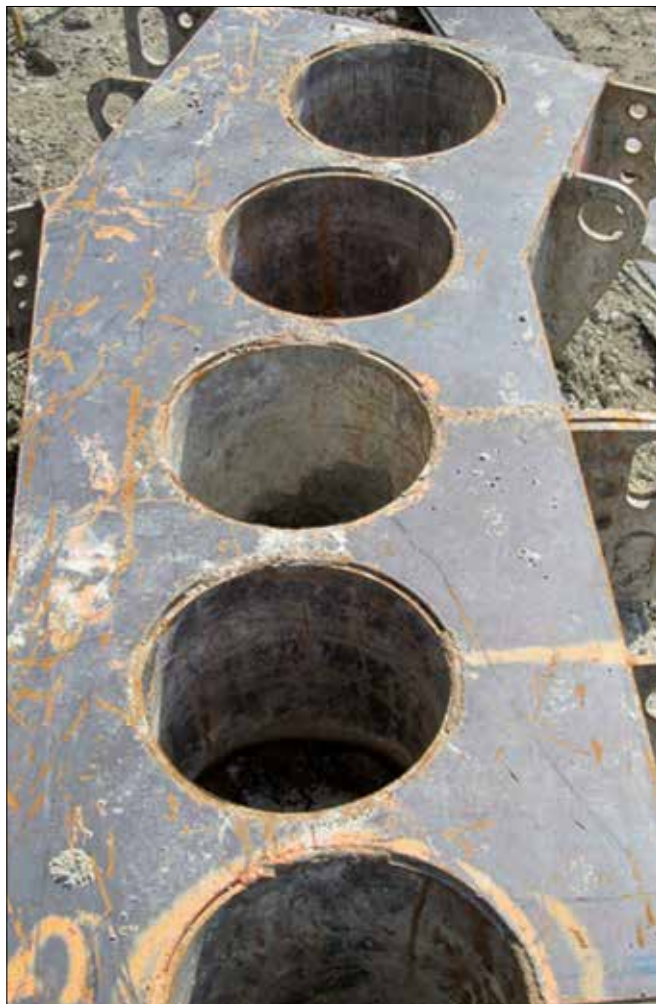
Fot. 8. Prowadnica stalowa wykorzystywana do stabilizacji narzędzia wiertniczego w planie przy wierceniu palisady
