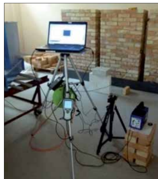
Fot. Stanowisko pomiarowe w klimatyzowanym Laboratorium Ochrony Budowli przed Wilgocią i Wodą Naporową UWM w Olsztynie do oceny skuteczności działania urządzeń osuszających przy zastosowaniu najnowszej generacji aparatury pomiarowej
