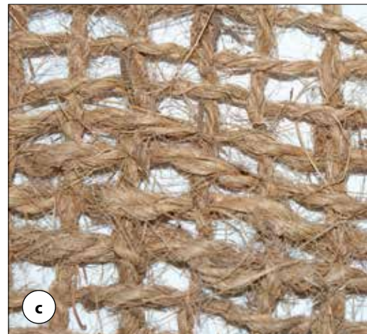
Fot. 3 | Przykłady materiałów z polimerów naturalnych ulegających biodegradacji: a) mata słomiana, b) mata kokosowa, c) tkanina jutowa
