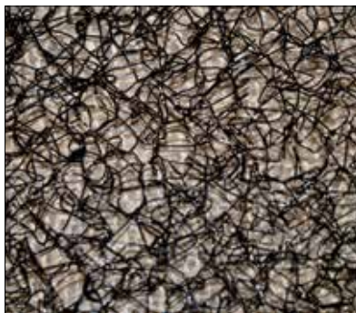
Fot. 6 | Geomata polipropylenowa połączona z tkaniną jutową
