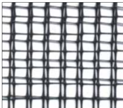
Fot. 4 | Płaska geosiatka przeciwoerozyjna z polimeru syntetycznego
