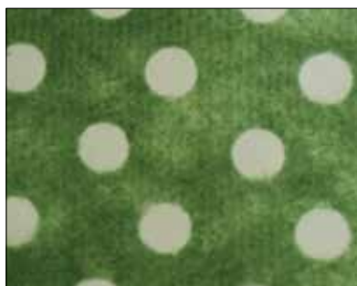
Fot. 8 | Przykład geowłókniny fotodegradowalnej
