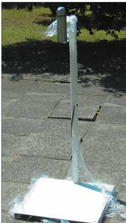
Fot. 4. Śniegowskaz ultradźwiękowy wchodzący w skład opracowanego zestawu przyrządów dla monitoringu pokrywy śnieżnej
