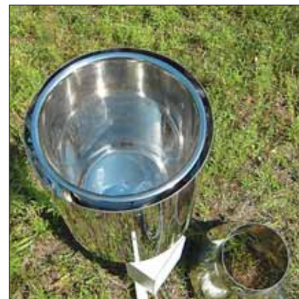
Fot. 5. Elektroniczny śniegomierz wagowy do pomiaru masy zdeponowanego śniegu, widok z góry, po otwarciu górnej części obudowy
