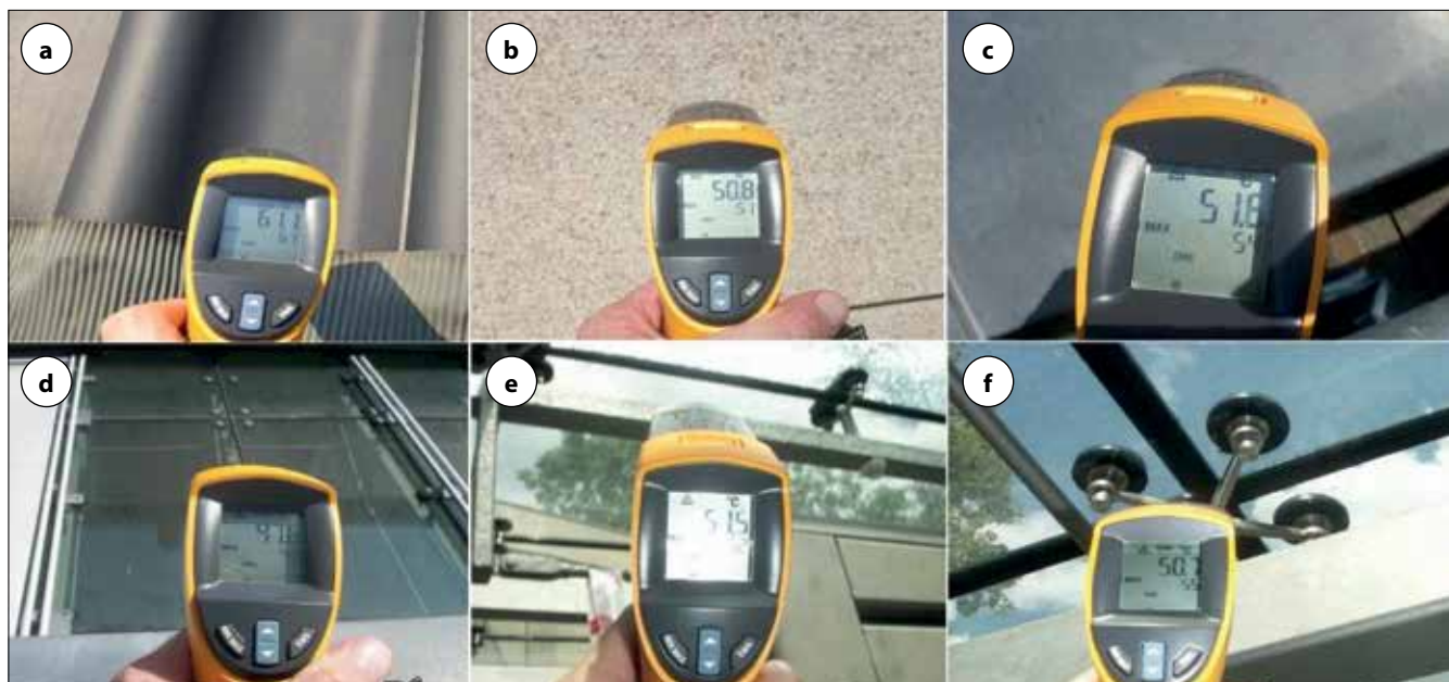
Fot. 2. Temperatury nagrzewania się pokryć dachowych (temp. otoczenia 30°C, w cieniu): a) dachówka w kolorze grafitowym, b) kamień lub beton, c) blacha cynkowa, d) szkło od zewnątrz, e) szkło od wewnątrz, f) stalowa konstrukcja wsporcza pod szkłem [1]
