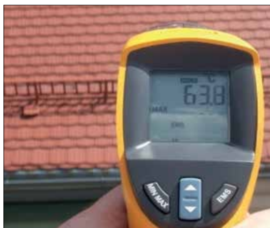
Rys. 2. Możliwe temperatury nagrzewania się pokryć dachowych w zależności od koloru pokrycia [1]
