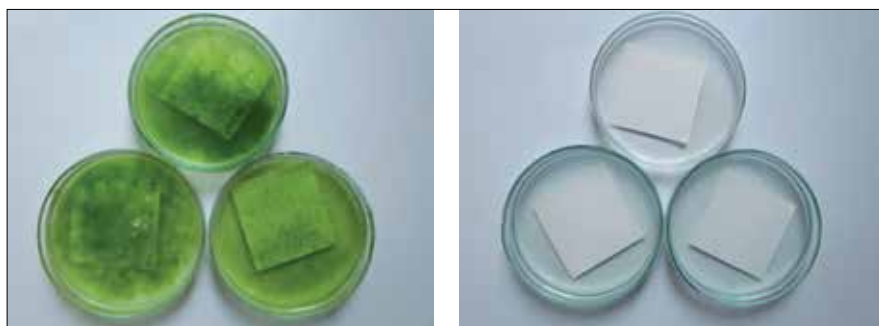
Fot. 1. Badania laboratoryjne skuteczności działania biocydów w powłoce z farby silikonowej. Powłoka bez biocydów i z dodatkiem biocydu
