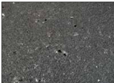
Fot. 11 | Punktowe nieciągłości (otworki) w masie KMB (fot. autor)
