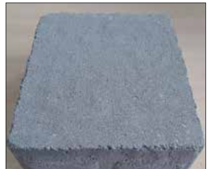
Fot. 6 | Uszkodzenia krawędzi kostki bezfazowej
