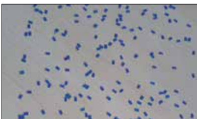
Fot. 8 | Zabezpieczenie warstw kostek drobkami tworzywa sztucznego
