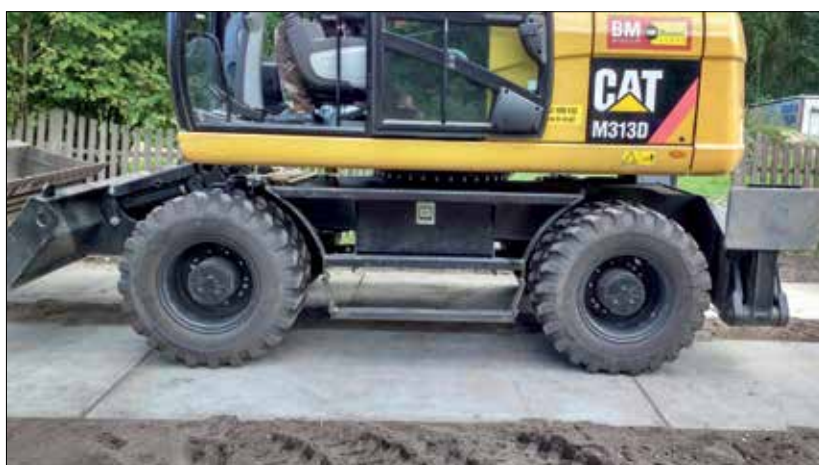
Fot. 6 | Koparka kołowa CAT M313D podczas jazdy na nawierzchni
