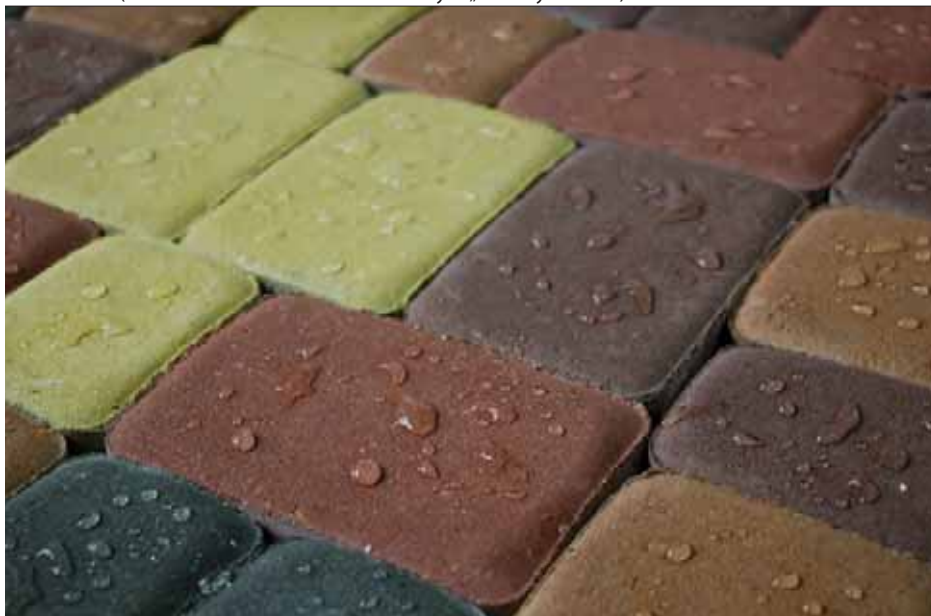
Kostka brukowa zaimpregnowana środkiem silikonowym Sarsil® bruk (fot. archiwum Zakładów Chemicznych „Silikony Polskie”)
