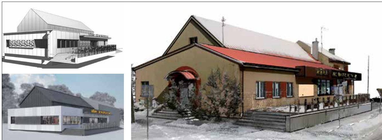
Rys. 4. Od chmury punktów przez inwentaryzację, koncepcję, wizualizację, po projekt dokumentacji technicznej. Droga ta wymaga poruszania się (wymiany danych) po paru oprogramowaniach, w tym przypadku Revit (Dynamo) – 3D Max-Vray – Adobe PS. Istotne jest odpowiednie przygotowanie modelu w Revit i kategorii elementów tak, aby eksport przebiegał bezproblemowo
