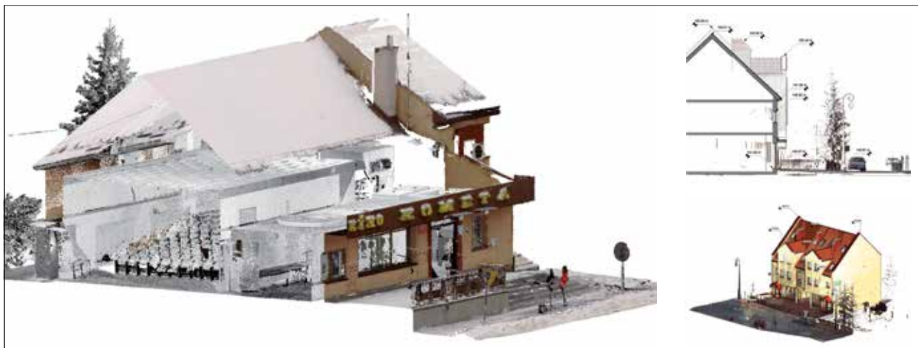
Rys. 2. Skan i model budynku kina. Obróbka chmury punktów musi odbywać się małymi elementami. Powinno się ustawić dużo widoków i przekrojów z odpowiednio zawężoną widocznością. Unikniemy nawarstwienia punktów (skan firmy Limbus Białystok)
