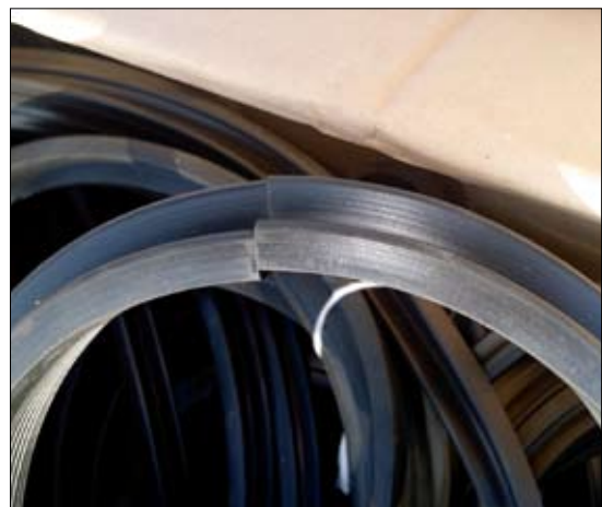
Fot. 13 | Wadliwa klinowa uszczelka elastomerowa
