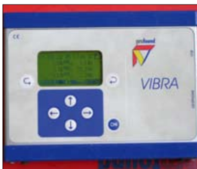
Fot. 6 | Urządzenie do rejestrowania drgań
