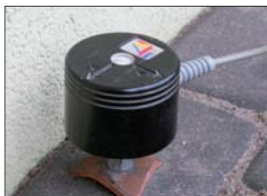
Fot. 7 | Akcelerometr do pomiaru przyspieszeń elementów konstrukcji budowli
