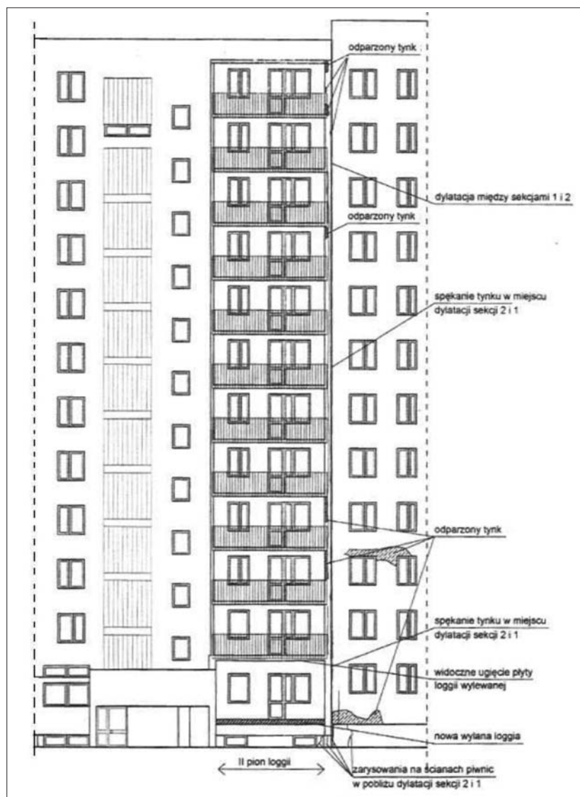
Rys. 4 | Przykłady żle uszczelnionej dylatacji pionowej między segmentami budynku wybudowanego w systemie Wk-70
