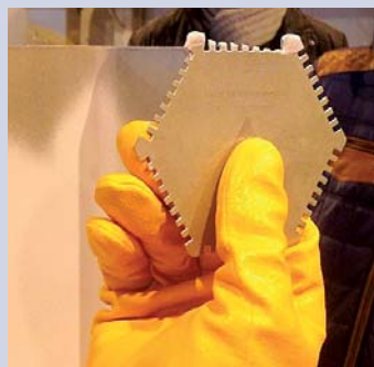
Fot. 1 Sprawdzenie grubości naniesionej świeżej warstwy farby z pomocą specjalnego grzebienia
